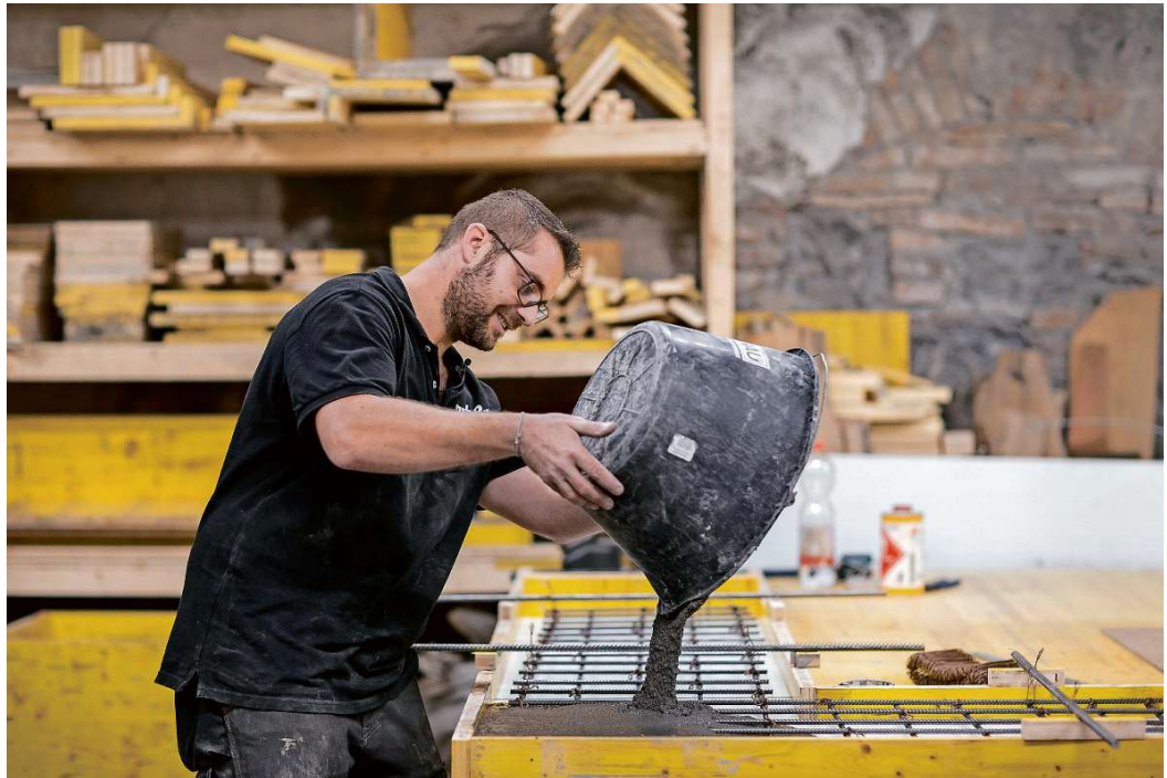
Der entscheidende Moment: Laszlo Szabo giesst seine schwarze Betonmischung in die vorbereitete Schaltung für eine Cheminée-Abdeckung.
